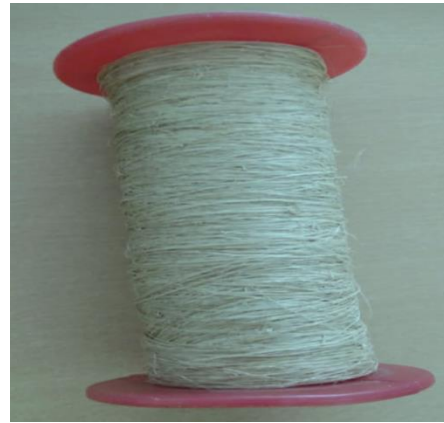
Gambar 6. Benang Serat Daun Nanas.
