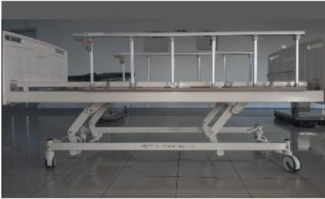
**Gambar15.** Prototipe tempat tidur pasien pada posisi teratas
