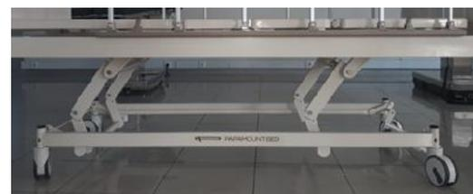
**Gambar 13.** Wujud fisik rangkaian mekanisme kinematik pengatur ketinggian
